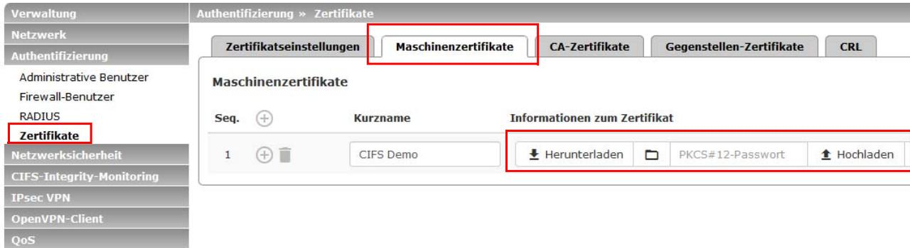
Bild 16-4 Installiertes Maschinenzertifikat zur Verwendung mit CIFS-IM
