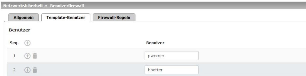
Bild 9-4 Benutzerfirewall-Template erstellen: Registerkarte *Template-Benutzer*
