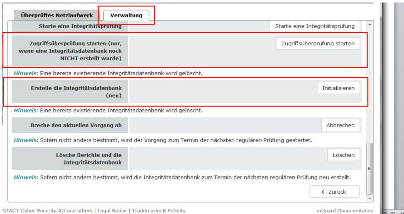
Bild 16-10 Integritätsprüfung vorbereiten und starten
