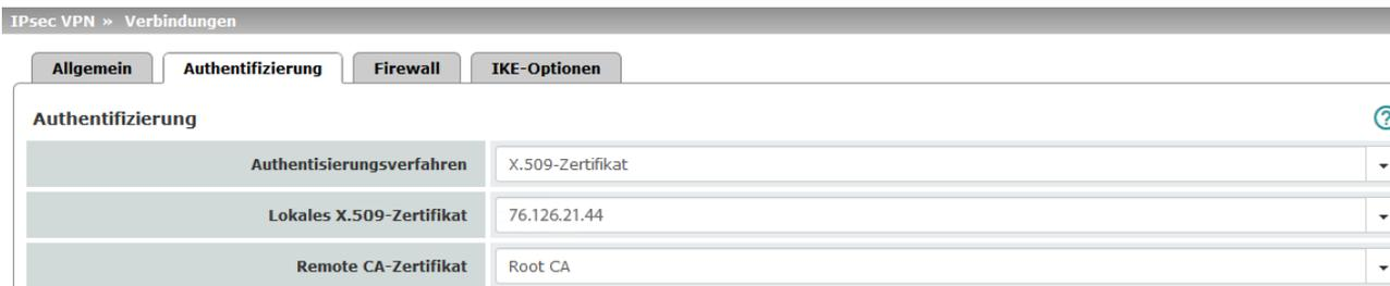
Bild 6-3 mGuard VPN-Konfiguration – Authentifizierung
