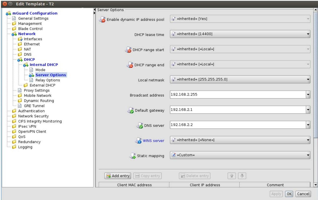
Bild 6-16 Einstellungen im erbenden Gerät
