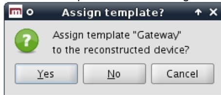
Bei Zuweisung des Templates zum Gerät werden die Variablen im Gerät auf Inherited gesetzt, sofern deren Wert (in der früheren Konfiguration) dem Wert im Template (in seinem aktuellen Zustand) entspricht.
